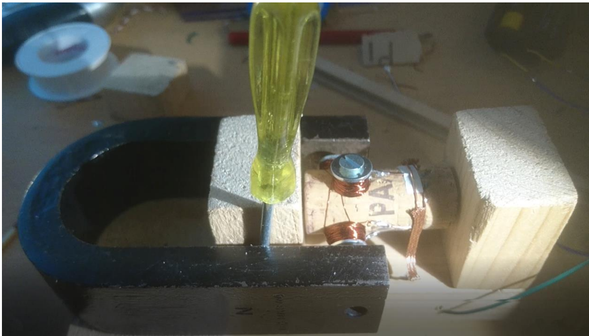
Abbildung 1 (Kork-Motor: Hufeisenmagnet, Stator, Kork-Rotor, Spulen, Kommutatoren, Kollektoren)
